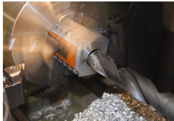
Bild 44: Ausbohren des Kurbelgehäuses
