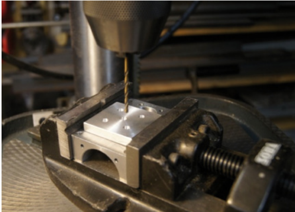
Bild 46: Vorbohren der Gewindelöcher
