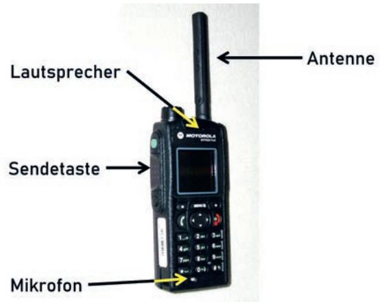
Abb. 1.8 Diese Komponenten des Funkgerätes haben wir schon kennengelernt.
