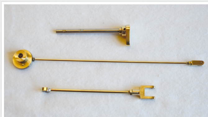
Kurbelwelle mit Kurbel, Kurbelstange und Exzenter mit Exzenterstange.
