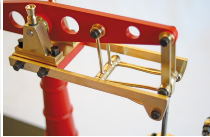
Ansicht von Balken, Hebelarm und der „Hebeleier“ für die Geradföhrung der Kolbenstange.
