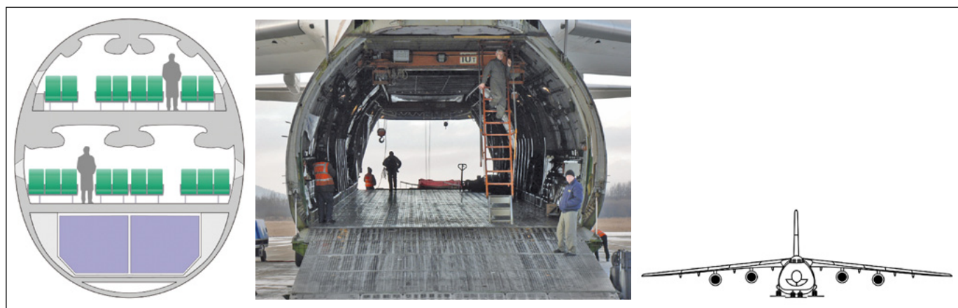
Abbildung 1: Querschnitte durch eine Passagiermaschine (Airbus A 380) und eine Frachtmaschine (Antonow An-124).
